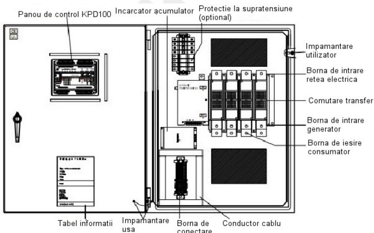
**Fig. 3-17 Aranjarea bornelor pentru comutator de transfer 4-poli de 250-400A (inc. comutator de transfer de 320A, similar cu 3-poli)**
