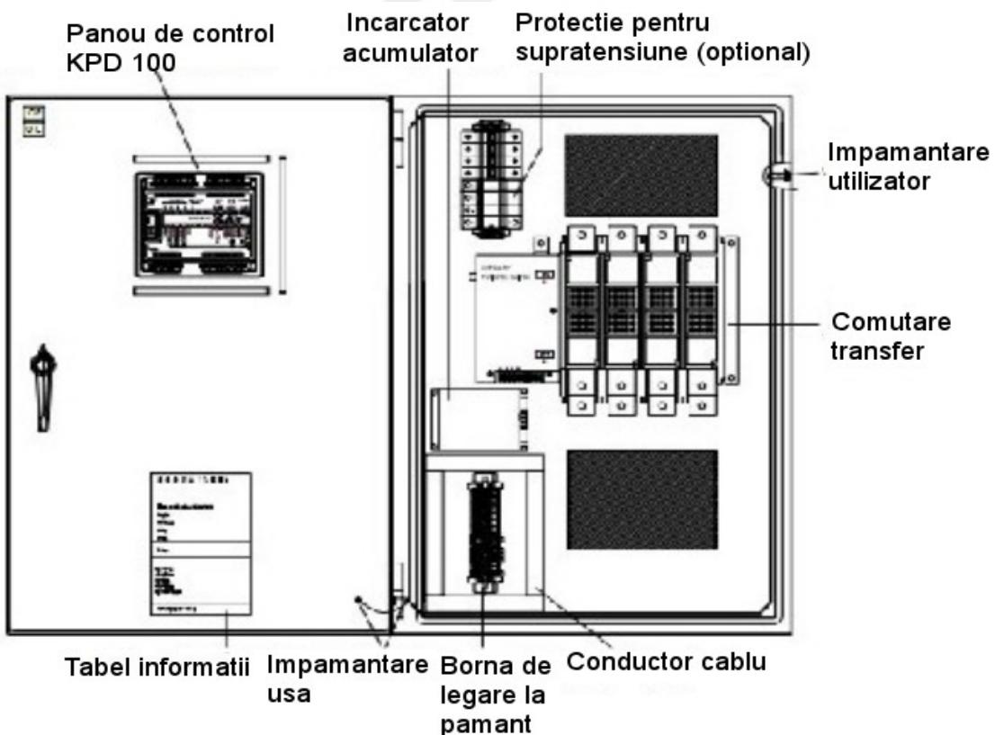
**Fig.3-9-1 Componentele interne pentru tipul montat pe perete: 250A-400A, comutator 4-polii**
