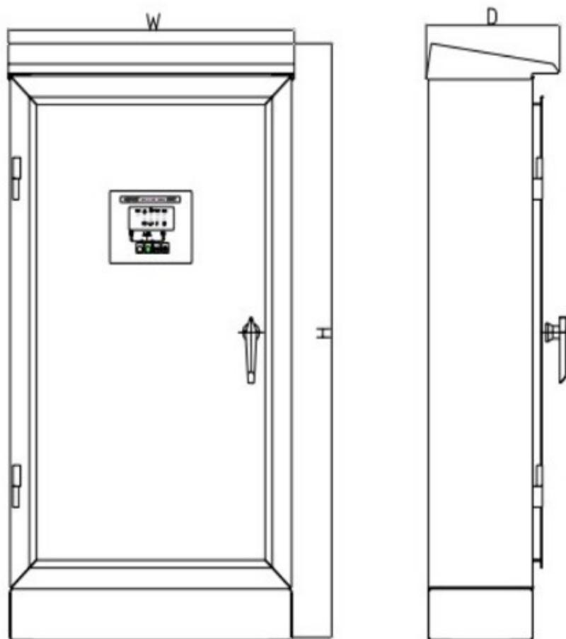
**Fig.3-6 Schita cutiei cu IP54**
