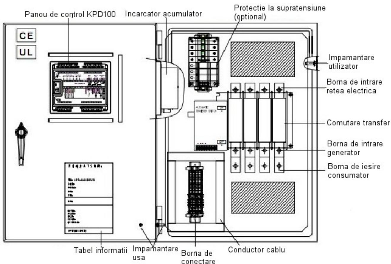
**Fig. 3-16 Aranjarea bornelor pentru comutator de transfer 4-poli de 40-200A (inc. comutator de transfer de 50A, 75A, 100A, 125A, 160A, similar cu 3-poli)**
