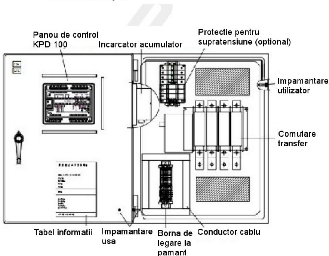
**Fig.3-7-2 Componentele interne pentru tipul podea: 40-200A, comutator 4-poli**
