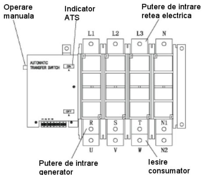
**Fig.3-2 Diagrama electrica pentru comutatorul de transfer cu 4-poli, 200A**
