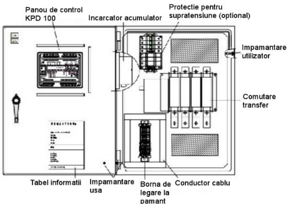
**Fig.3-7-1 Componentele interne pentru tipul podea: 40-200A, comutator 4-poli**
