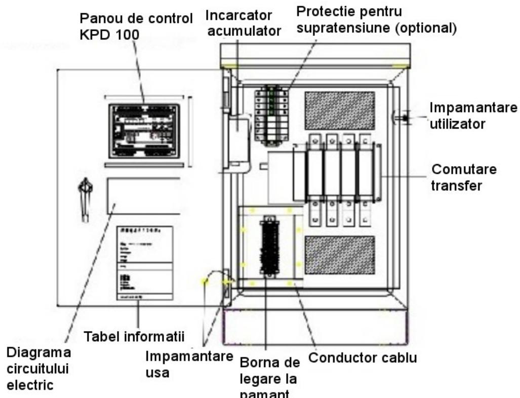
**Fig.3-9-2 Componentele interne pentru tipul podea: 250A-400A, comutator 4-polii**
