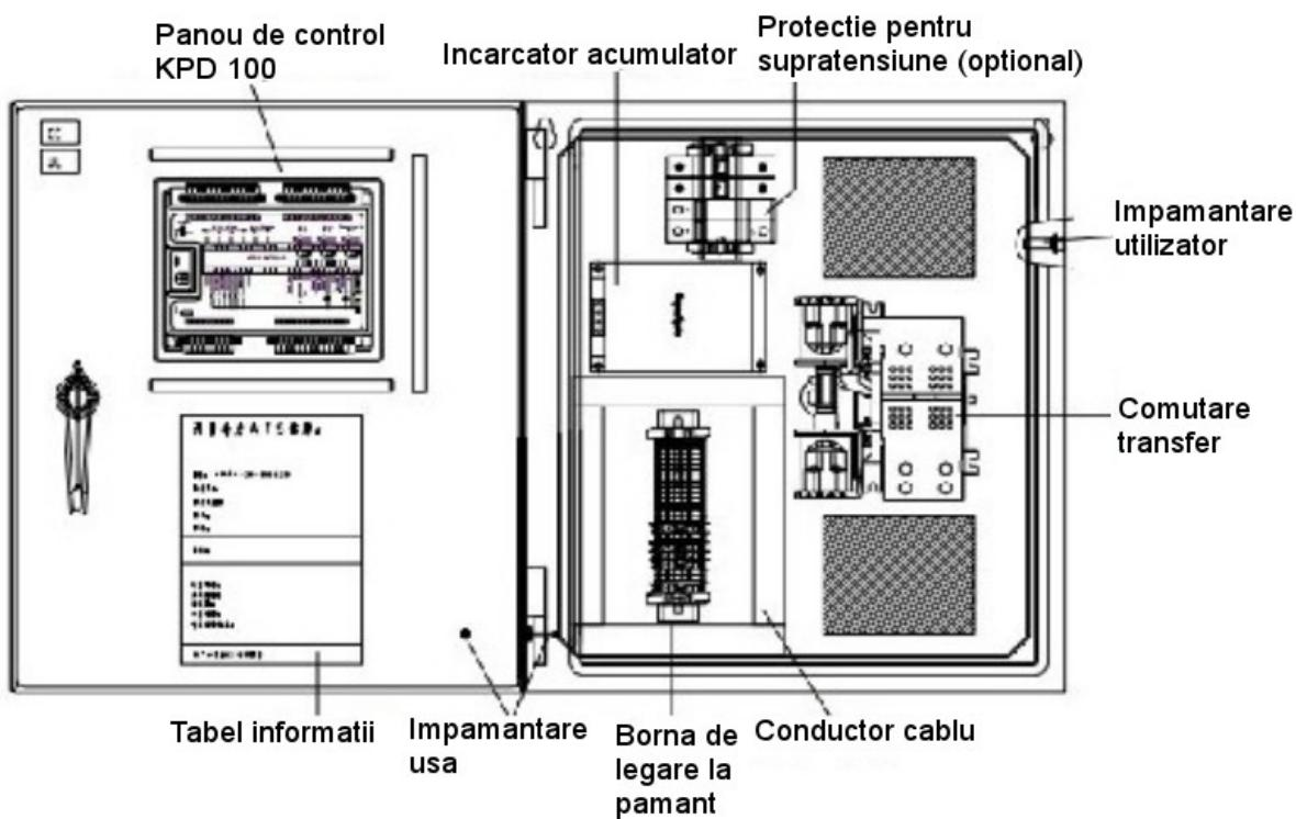
**Fig.3-8 Componentele interne pentru tipul montat pe perete: 100A si 200A, comutator 2-polii**
