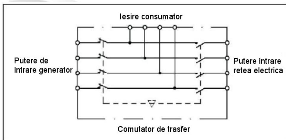
**Fig.3-4 Diagrama pentru alimentare electrica ATS: putere generator - consumator**
