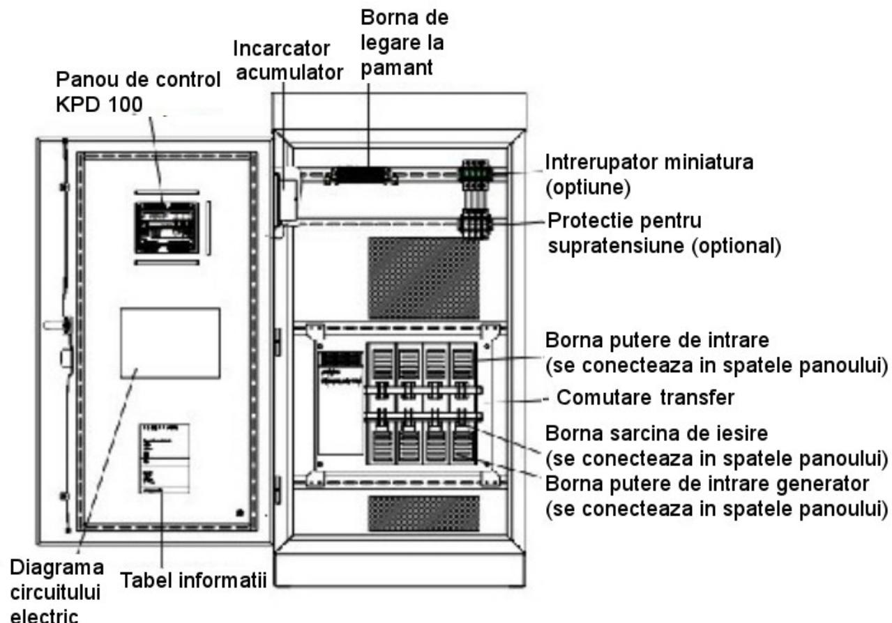
**Fig. 3-18 Aranjarea bornelor pentru comutatorul de transfer 4-poli de 630-1600A (inc. Comutator de transfer de 800A, 1250A)**
